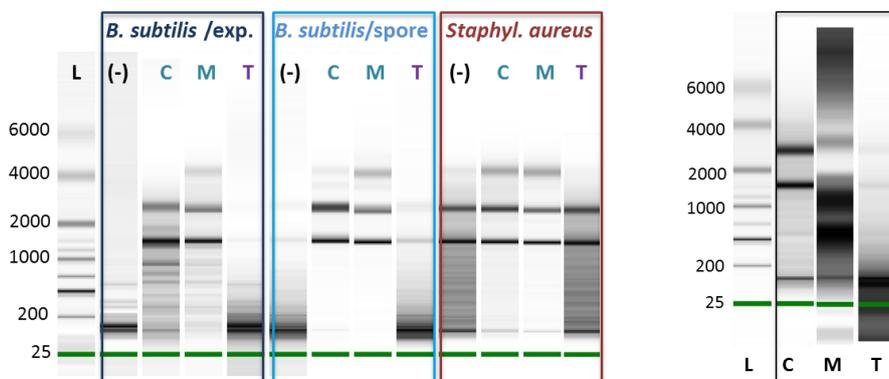
FIGURE 3: COMPARISON OF DIFFERENT HOMOGENIZATION METHODS. SHOWN IS THE RNA QUALITY USING RNA 6000 PICO CHIP (BIOANALYZER, AGILENT). BACTERIAL SAMPLES ARE SHOWN ON THE LEFT SIDE; FECAL SAMPLES ARE SHOWN ON THE RIGHT SIDE. LEGEND: EXP., EXPONENTIAL GROWTH PHASE; L, LADDER; (-), WITHOUT HOMOGENIZATION STEP; C, CRYOPREP; M, MICRODISMEMBRATOR; T, TISSUE LYSER. THE LABELLING FOR THE LADDER IS GIVEN ON THE LEFT SIDE.
